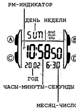
На рисунке изображен общий вид часов в Режиме Текущего Времени. Нажмите кнопку "С" для перехода из режима в режим в следующей последовательности:
